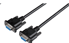
RS-232C線纜 L9637 用於外部控制，雙重盾 9針 - 9針 線長3 m
