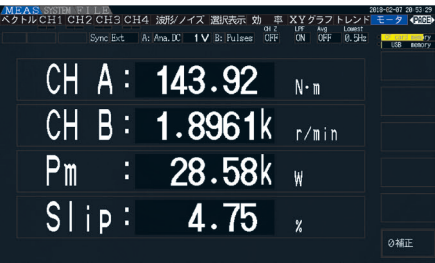
馬達解析畫面（扭矩、轉數、馬達功率、轉差率） CH B 中輸入編碼器的 Z 相脈衝、電氣角、B 相脈衝的話，則可測量旋轉方向。
