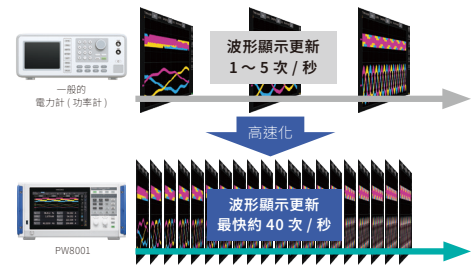
取樣速度高達40次/秒，媲美示波器
