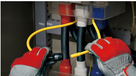
柔性電流感測器可輕鬆穿過狹窄空間進行測量
