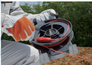
接地電阻測量需要插入輔助接地極，還需要將線纜拉長到20m的長度，在測量上非常花時間。FT6041能夠縮短測量時間。
