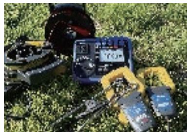
只需一台FT6041就可以進行接地電阻、地面電阻的測量。此外，使用勾式感測器，不需要將接地極拔出也可以進行測量，非常方便使用。
