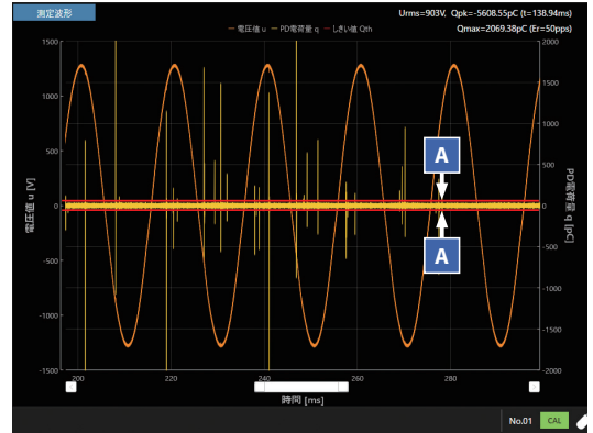
部分放電檢測的閾值設定
