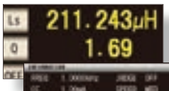
L,Q顯示介面(1kHz, CC1mA測量)
