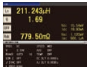
L,Q,Rdc連續測量介面 L, Q(1kHz, CC1mA測量)和 Rdc(DC測量)的顯示介面
